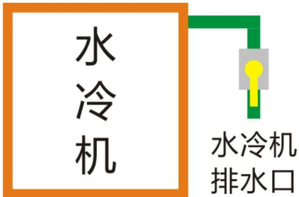
最后打开水冷机的排水口将最后水箱内余水排空。
