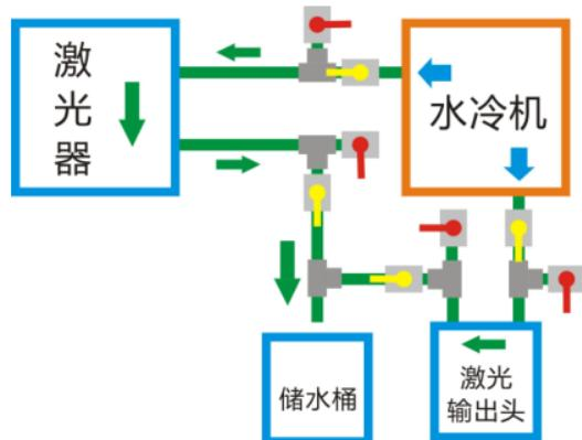
水冷机开机状态下关闭红色阀，打开黄色阀，这时水冷机会把内部水箱的水主动泵到储水桶中，直至没有大量水流时关闭水冷机电源。
