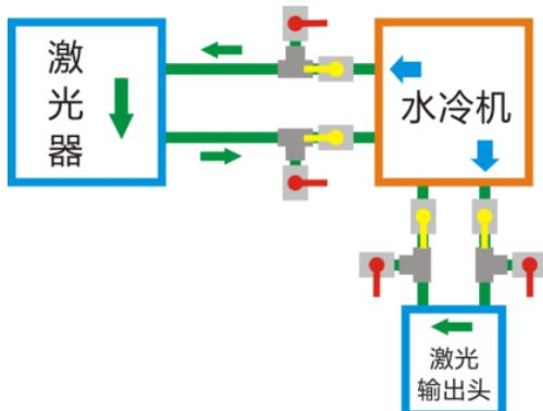
3. 关机前先使用水冷机主动排空：
