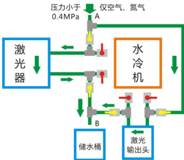
按图示要求关闭红色标示阀门，打开黄色标示阀门，向 A 处通入不高于 0.4Mpa (4 公斤以内) 的干净压缩空气或氮气，直至 B 点出水口没有水吹出。
